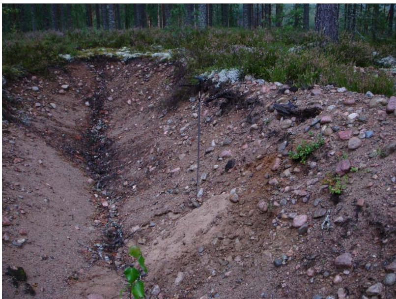
Kuva 6. Pitkäkankaan päällä menevän ajotien varressa olevan ojaleikkauksen pinnalta soravaltaista ainesta, joka noin 0,8 metrin syvyydessä muuttui hiekkavaltaiseksi. Kuva © Tapio Väänänen / GTK.
