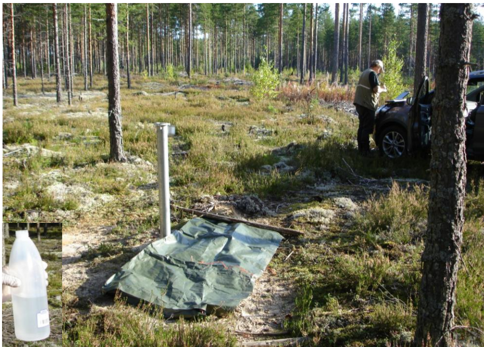
Kuva 5. Pohjavesinäytteenoton valmistelua Haapavuoren muodostuman havaintoputkella HP30-2012. Kuvan vasemmassa alareunassa on vesinäyte, joka on otettu syvyydeltä 11-12 m. Syvemmältä otettu näyte ei ollut kirkastunut täysin. Kuvat © Tapio Väänänen / GTK.
