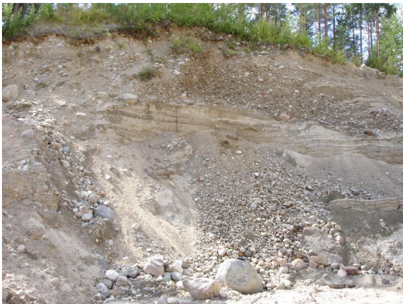
Kuva 3. Kortteenlahden maa-ainesten ottoalueen leikkaus. Pinnalla aines oli karkeaa ja soravaltaista, alempi kerros oli hietavaltaista (16.8. 2012). Kuva © Tapio Väänänen / GTK.
