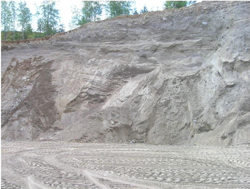
Kuva 3. Hiekkamonttuleikkaus muodostuman pohjoisosassa, jossa hiekan päällä on moreenikerrostuma. Kuva © Jouko Saarelainen /GTK.
