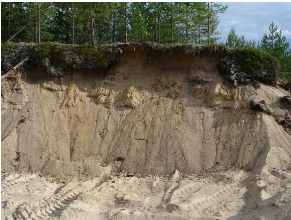
Kuva 3. Suomuslahden pohjoisosan ottoalueen hiekka - hietavaltainen leikkausseinämä. Kuva © Tapio Väänänen / GTK.
