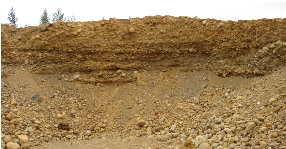
Kuva 4. Piilukonkankaan ottoalueen leikkausseinämän kivistä soraa. Kuvan keskiosassa olevan kartoituspiikin korkeus on noin 1 metri (24.5.2013). Kuva © Tapio Väänänen / GTK.
