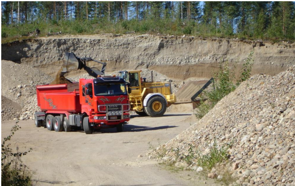
Kuva 5. Pusukanharjun maa-ainesten ottoalue. Leikkausseinämän yläosassa on näkyvissä kivistä hyvin pakkautunutta maa-ainesta, jossa on kivistä soraa, mutta jossain määrin myös hienompia lajitteita. Yläpuolinen kerros leikkaa alemman hiekkavaltaisen kerrostuman virtakerroksellisuutta. Kuva © Tapio Väänänen / GTK.
