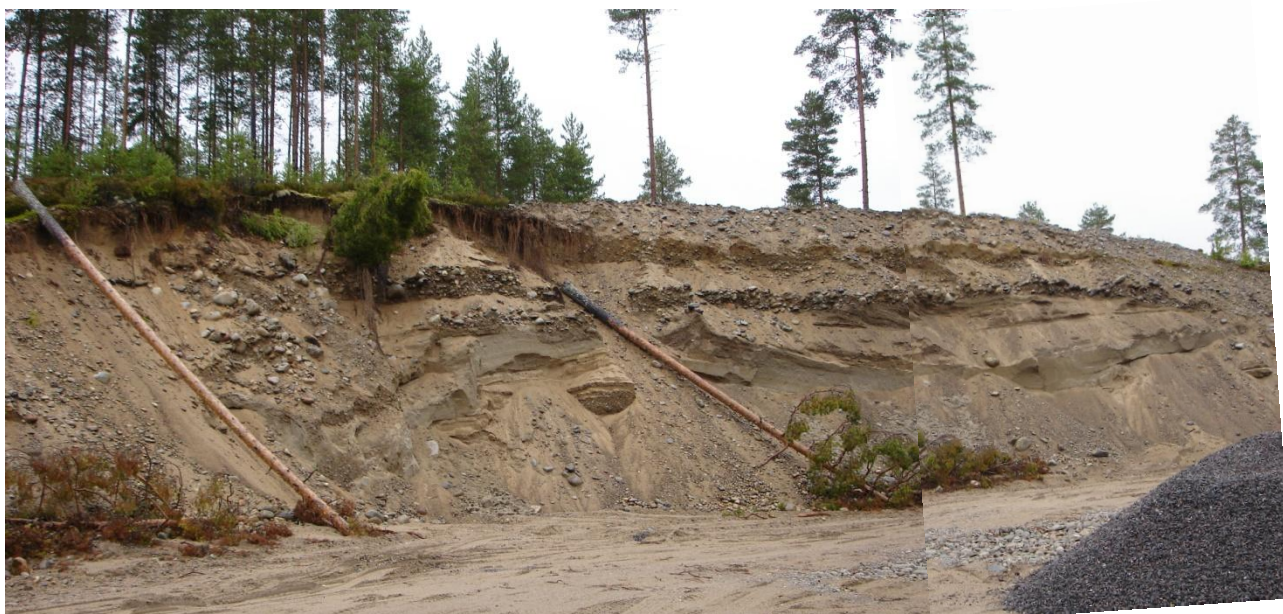
Kuva 7. Ylemmässä kuvassa olevan leikkausseinämän jatkoa itään päin. Noin 3 metrin syvyydellä maanpinnasta on nähtävissä kerros kivistä sora, jonka alla on hiekkavaltaista ainesta. Kuva on otettu 5.10.2012. Kuva © Tapio Väänänen / GTK.
