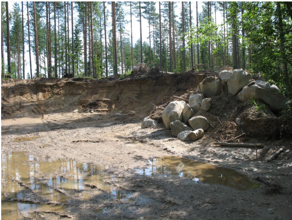
Kuva 6. Kangasselän muodostuman ottoalueen leikkaus. Hiekkavaltainen aines on sisältänyt ylisuuria lohkareita ja kaivuussyvyys on ulottunut lähelle pohjaveden pinnan tasoa. Kuva on otettu 24.7.2012. © Timo Huttunen / GTK.
