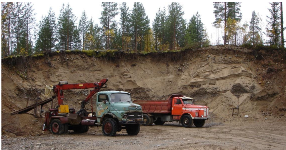
Kuva 6. Tutkimusalueen itäosassa olevan maa-ainesten ottoalueen leikkausseinämä. Kivisen aineksen ja hiekkavaltaisten kerrosten vaihtelua. Kuva on otettu 5.10.2012. Kuva © Tapio Väänänen / GTK.
