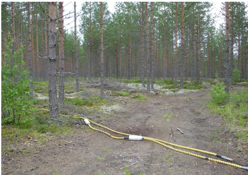
Kuva 3. Haarajoen muodostuman tasaista hiekkavaltaista pintaa lähellä kairauspistettä HP1-2012. Etualalla on näkyvissä maatumkan 100 ja 25 MHz letkuantennit. Kuva otettu 20.6.2012 © Tapio Väänänen / GTK.
