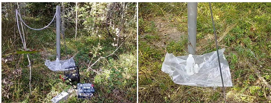
Kuva 5. Oikeassa kuvassa HP29-2011 pohjavesinäytteen otto Moon Soon -sähköpumpulla ja pohjavettä syvyydeltä 4,5-5,5 m näytetullossa (4.9. 2013). Kuvat © Arto Kiiskinen/GTK.
