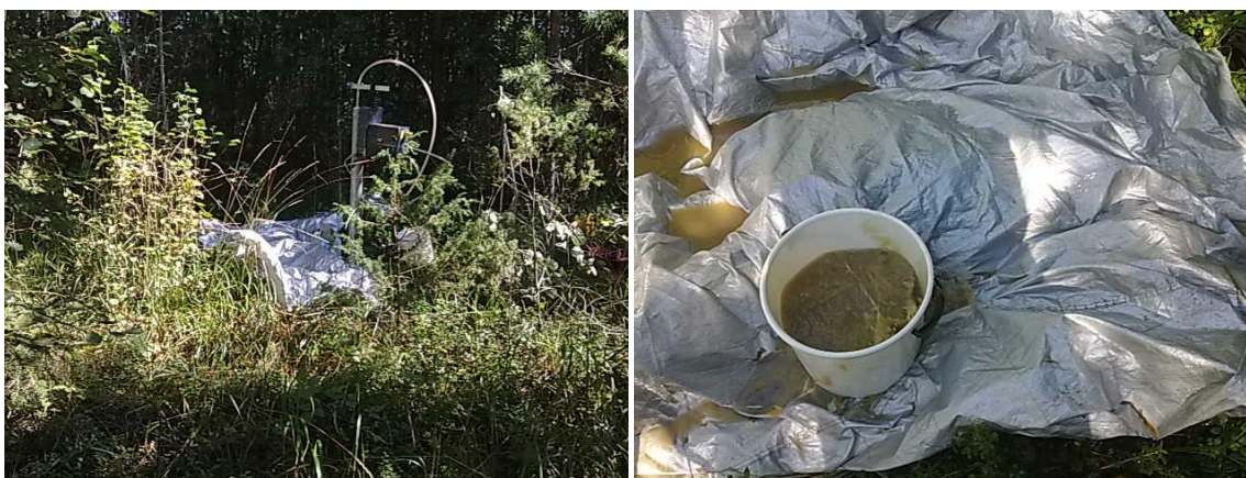
Kuva 4. HP29-2011 havaintoputken heinittynyttä ympäristöä ja sytkypumpulla pumpattua lietteistä pohjavettä sanokossa (16.8. 2013). Kuvat © Arto Kiiskinen/GTK.
