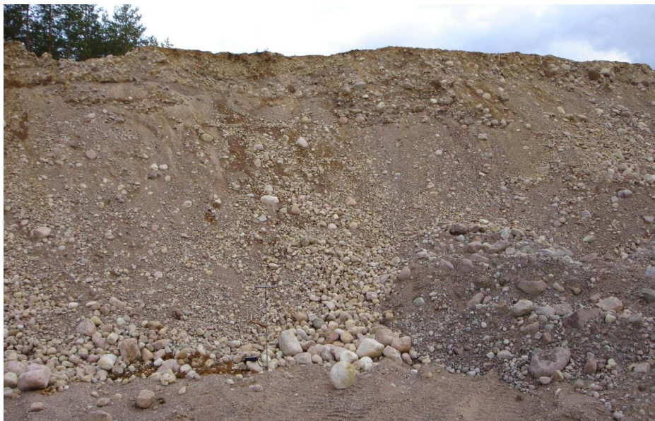
Kuva 3. Susimäen eteläosassa olevan uuden maa-ainesten ottoalueen leikkausseinämän soravaltaista ainesta. Kuva © Tapio Väinänen / GTK.
