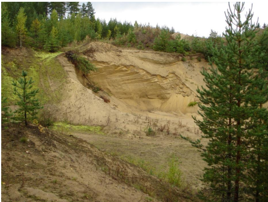
Kuva 3. Kaamalonkankaan ottoalueen hiekkavaltainen leikkauseinämä. Kuva © Tapio Väänänen / GTK.
