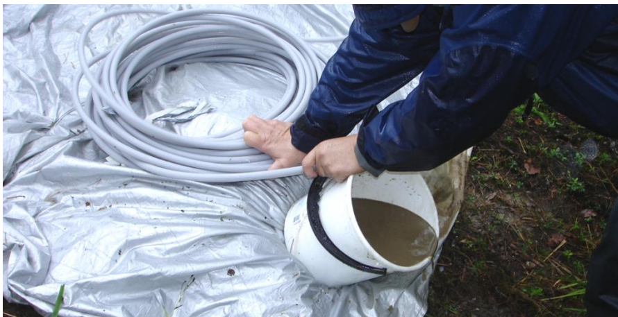
Kuva 19. HP7-2012 havaintoputken huuhtelussa tullutta lietteistä, hienoainespitoista pohjavettä. Kuva © Tapio Väänänen / GTK.
