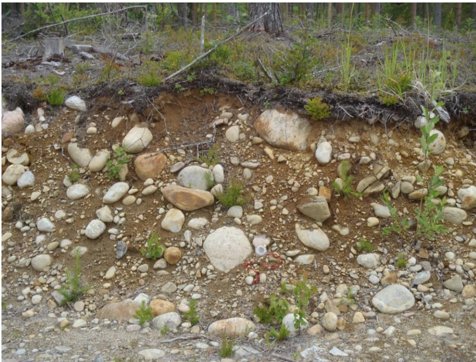
Kuva 5. Mustakankaan pohjoisosan uuden metsäautotien leikkaus. (KKJ3 i:3 629 900, p: 6 844 200 m) Tien varrella oli useita 1-2 metriä syviä leikkauksia, joissa aines oli pintaosastaan osittain heikosti lajittunutta sora. Kuva © Arto Kiiskinen /GTK.
