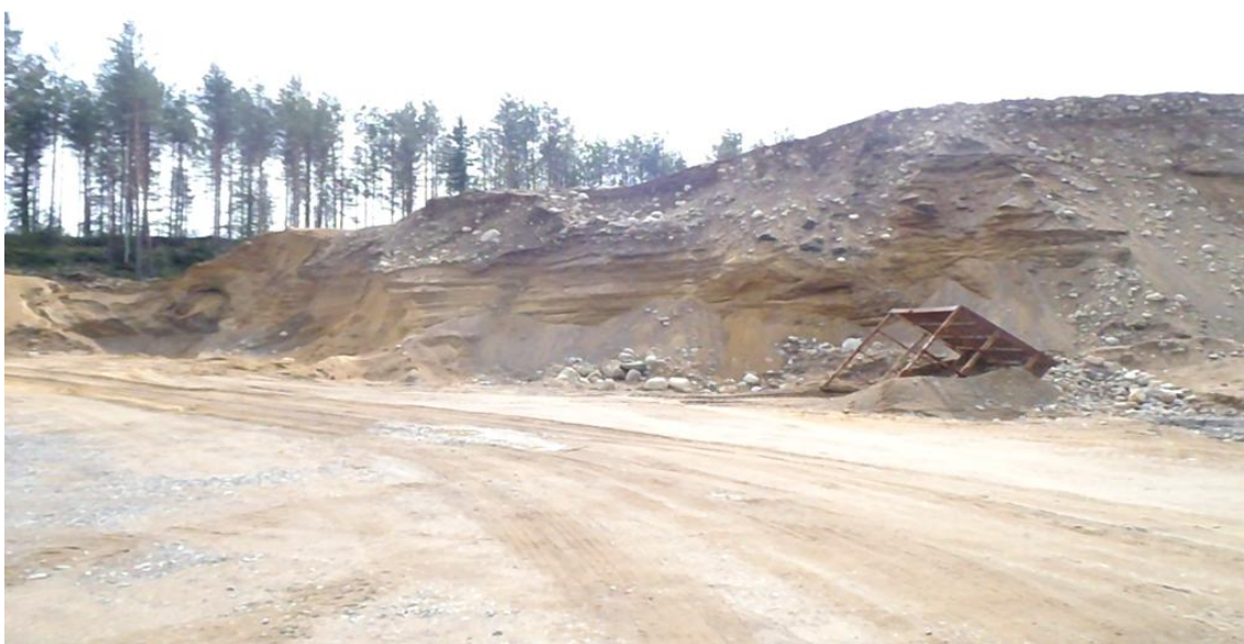
Kuva 4. Haukilammen itäosan kaivettua muodostumaa (KKJ3 i=3 630 835, p= 6 850 950 m). Leikkauksen yläosassa oli noin 2 metriä hiekaista soraa ja sen jälkeen noin 6 metriä vaakakerroksellista hiekkaa. Kuvaussuunta etelään. Kuva © Arto Kiiskinen / GTK.
