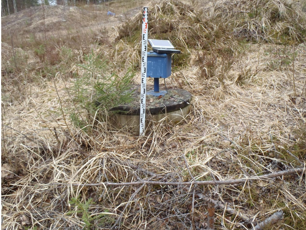
Kuva 10. Liittolahden kaivettua koillisosan maisemoitua muodostumaa. Kuopan pohjalla oli kaivo (i:3 629 516, i: 6 851 894). Pohjavedenpinta oli kk. 2,41 m. (kk - mp 0,2-0,3 m). Kaivo oli todennäköisesti käytössä. (pumppu kannessa). Kuva © Arto Kiiskinen / GTK.
