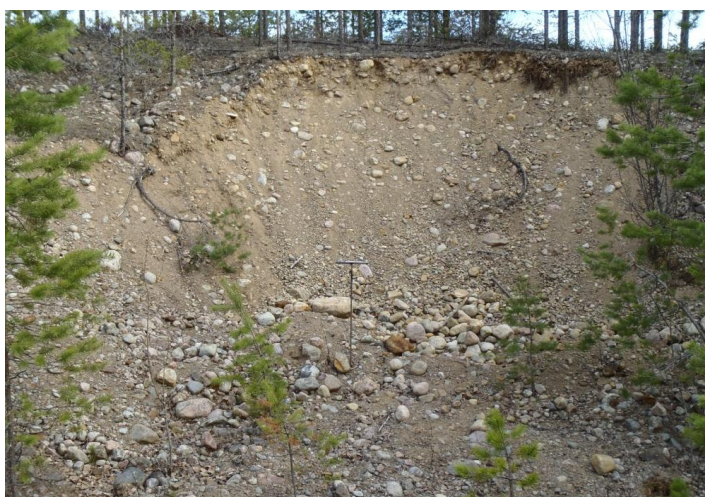
Kuva 4. Saarijärven koillispuolella oleva leikkaus (KKJ3 i:3 614 500, p: 6 833 100 m). Seinämän korkeus on noin 4 metriä ja aines on soraista hiekkaa. Kuva © Arto Kiiskinen / GTK.
