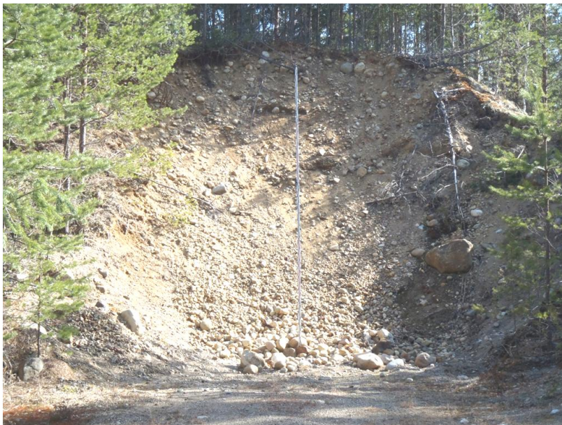
Kuva 3. Purnulahden itäpuolen muodostuman (KKJ3 i:3 629 220, p: 6 842 740 m) kaivettua luoteiskärkeä. Seinämän korkeus oli noin 7 metriä korkea ja aines oli hiekkaista soraa, joka sisältää 5-10 % kiviainesta. Kuva © Arto Kiiskinen /GTK.
