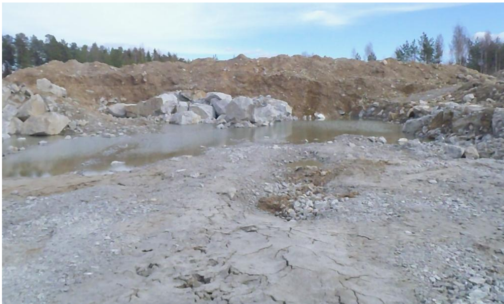
Kuva 4. Liittolahden kaivettua soraharjua. (KKJ3 i:3 630 153, p: 6 851 070 m). Aines oli leikkauksessa soraista hiekkaa. Seinämän korkeus oli noin 5 m. Kuvassa oikealla oli kallio. Kuva © Arto Kiiskinen / GTK.
