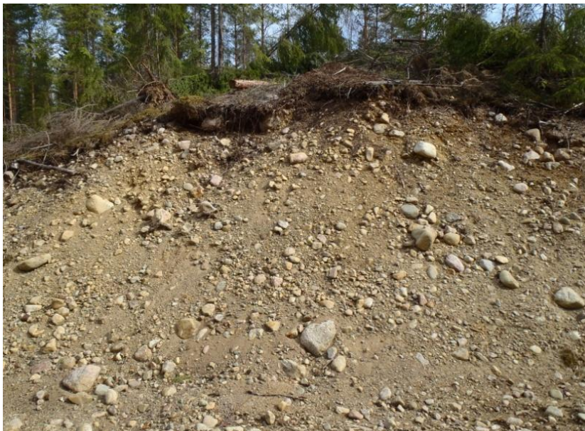
Kuva 5. Tieleikkauksessa olevaa soraista hiekkaa muodostuman pohjoisosan kalliomäen kupeessa. Kuva © Arto Kiiskinen / GTK.
