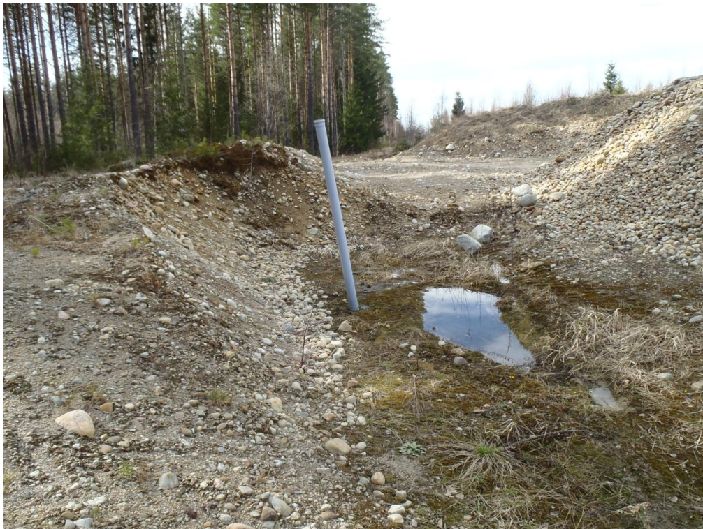
Kuva 11. Karhusuon lounaispuolen pienialainen maa-aineksenottoaika, jossa oli pohjavesiputki. Pohjavedenpinta oli hpp. 2,75 m. (mp-pp. 2,2 m). Putki soveltuu vain pohjavesipinnan tarkkailuun. Kuva © Arto Kiiskinen / GTK.
