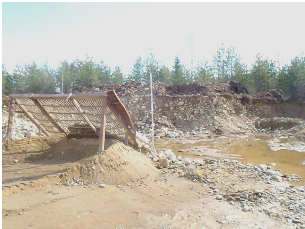
Kuva 3. Liittolahden kaivettua soraharjun itäosaa. (KKJ3 i:3 630 181, p: 6 851 180 m). Aines oli leikkauksessa hiekkais-ta soraa. Kuvaussuunta itään. Kuva © Arto Kiiskinen / GTK.
