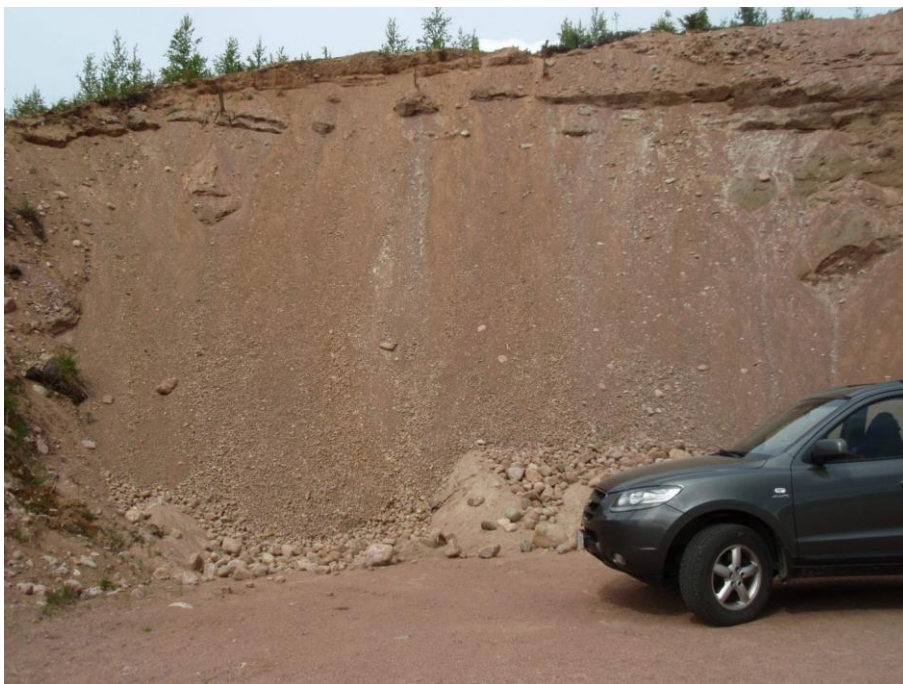
Kuva 4. Rajalahden (KKJ3 i: 3 608 955, p: 6 828 211 m) deltamaisen kankaan eteläpuolen maa-ainesten ottopaikka. Kuvaussuunta pohjoiseen. Seinämän korkeus noin 10 metriä. Aines oli vaakakerroksellista hiekkaa ja hietää. Leikkaus oli pahoin valunut. Kuva © Arto Kiiskinen /GTK.
