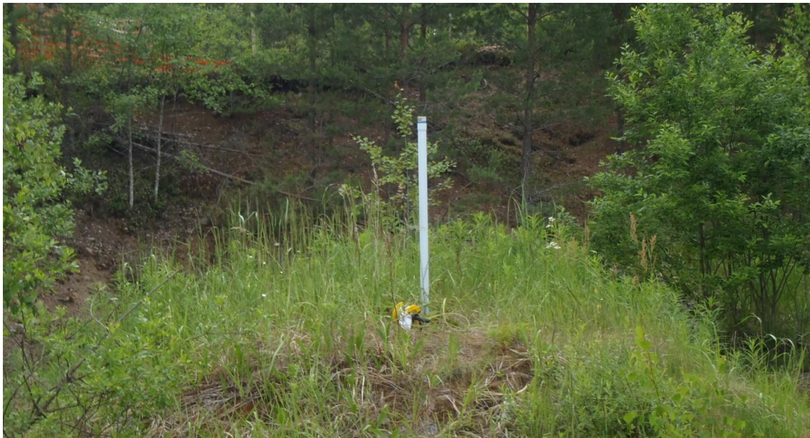
Kuva 4. Pieni Viitalammen itäpuolella (KKJ3 i:3 599 745, p: 6 839 760 m) oleva pohjavesiputki. Kuvaussuunta luoteeseen. Pohjavedenpinta oli kesäkuun lopulla 4,51 m pp. Maanpinta-putkenpää 2,47 m. Kuva © Arto Kiiskinen / GTK.
