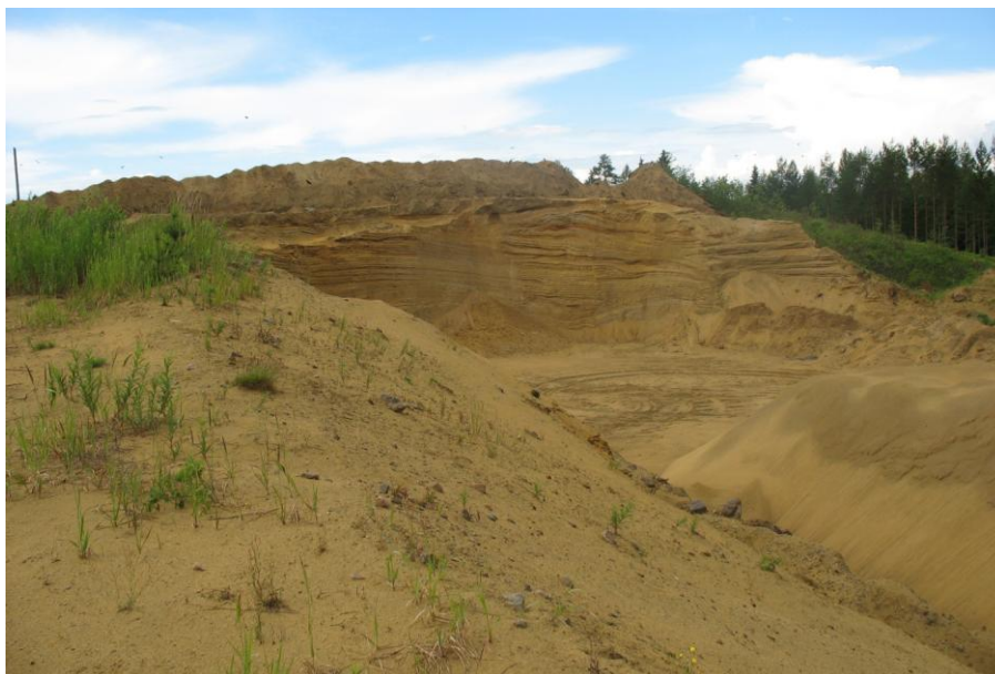
Kuva 3. Maa-ainestenottoa Nousialan jäteaseman eteläpuolisella hiekkakumpareella, materiaali on hiekkavaltaista kauttaaltaan. Kuva © Jari Hyvärinen.
