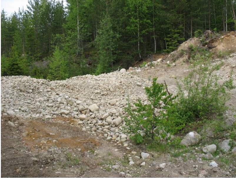
Kuva 3. Ottoaluetta Aumaniemen alueella tutkimusalueen pohjoisosassa. Materiaali ottoalueella on soravaltaista, muutoin muodostuma pääosin hiekkaa. Kuva © Jari Hyvärinen / GTK.
