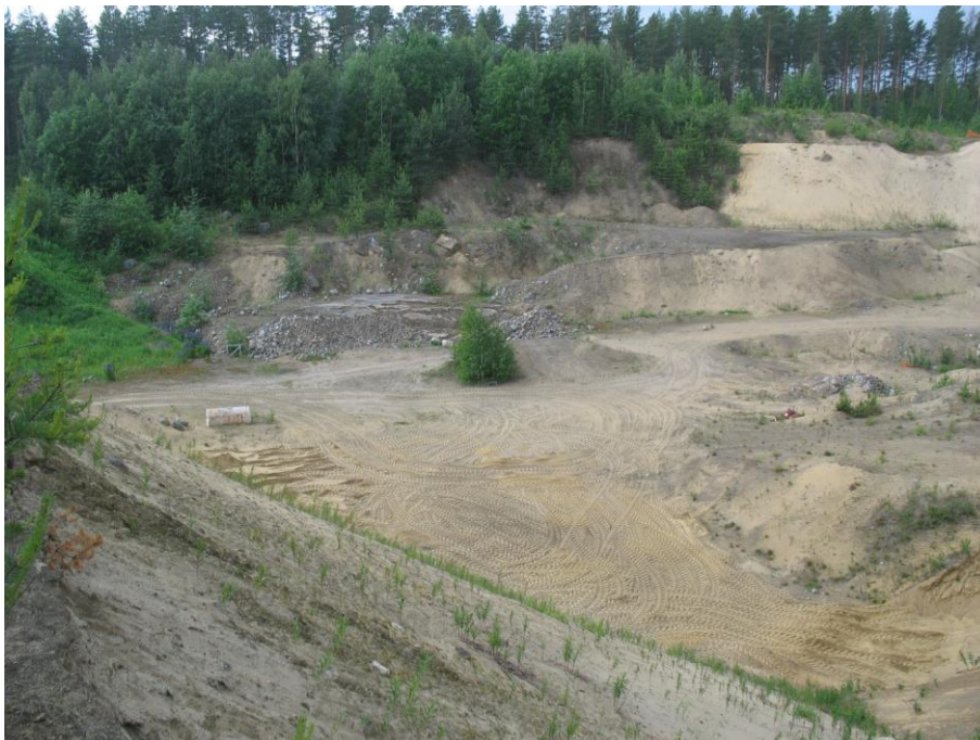
Kuva 4. Monttu keskellä Soukankankaan muodostumaa, keskellä on nähtävissä oton myötä esiin tullut kallioalue. Materiaali on hiekkavaltaista, aivan pohjalla lähellä kallionpintaa karkeampaa. Kuva © Jari Hyvärinen / GTK.
