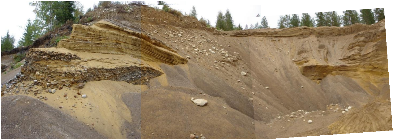
Kuva 4. Ryöpänharjun maa-ainesten ottoalueen eteläpään käytössä oleva leikkaus. Maatutkaluotauslinja L3 on vedetty kuvan oikean alareunan kohdalta. L5 ja L6 linjat vedettiin leikkauksen yläosan kuoritun alueen kautta. Kuvaussuunta kaakkoon. Kuvamosaiikki © Tapio Väänänen / GTK.
