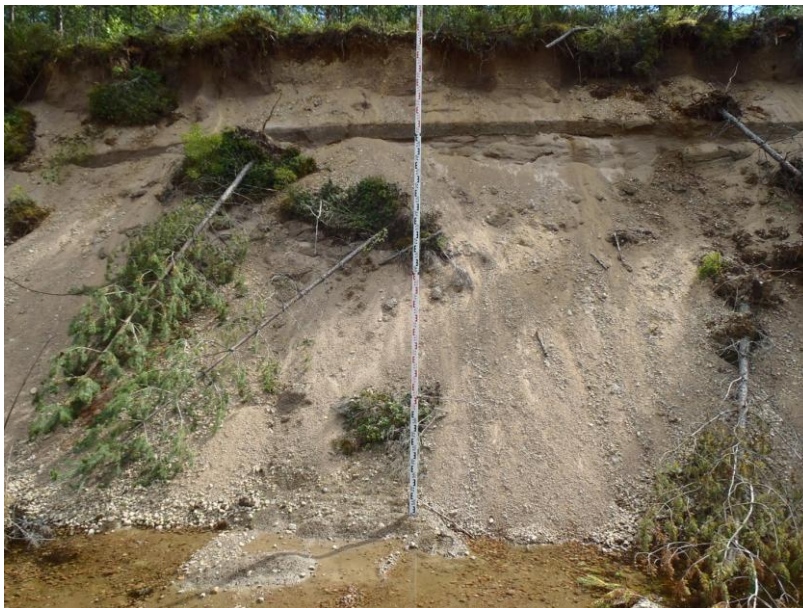
Kuva 5. Patalamminkankaan kaakkoisosassa (KKJ3 i: 3 600 854, p: 6 826 945 m.) sijaitseva maa-ainesten otto-paikka. Seinämän korkeus oli noin 8 metriä. Pinnalla oli noin 1 metri soraista hiekkaa, sitten 0,2 metriä kerroksellista hietaa ja hienoa hietaa. Keski – alaosa oli valunut, mutta aines oli todennäköisesti kerroksellista hiekkaa. Pohjalla seiso i vesi. Kuva © Arto Kiiskinen /GTK.
