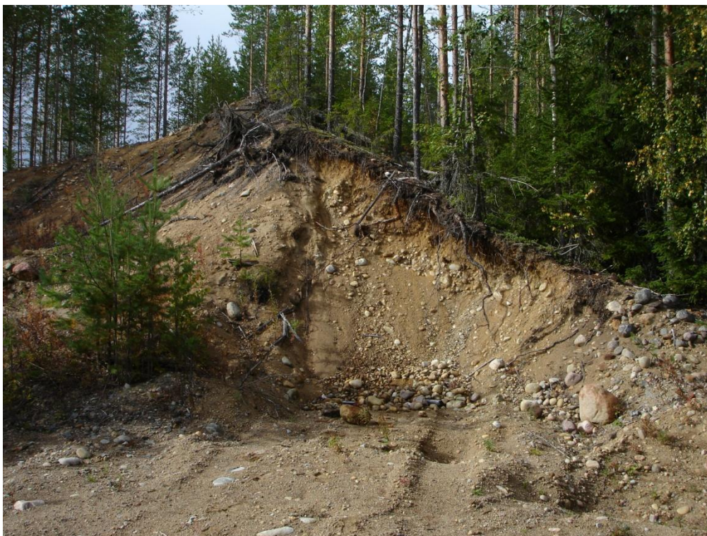
Kuva 3. Musta-Olhavin harjun eteläpäässä olevan pienen ottoalueen leikkausseinämä. Pintaosan maa-ainesta sisältää jonkin verran hienoainesta.
