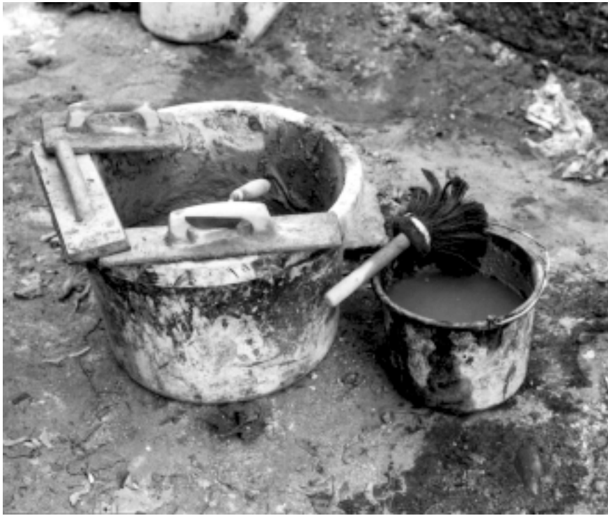
Kuva 5. Muurauksessa ja rappaamisessa käytettävät työkalut ovat säilyneet lähes samanlaisina niin kauan kuin rappausta on tehty. Muuraus- ja rappauskauha, puinen hierrin sekä kastelusuti ovat tämänkin päivän työkaluja. Muovipalju on nytemmin korvannut puisen laastiastian.
