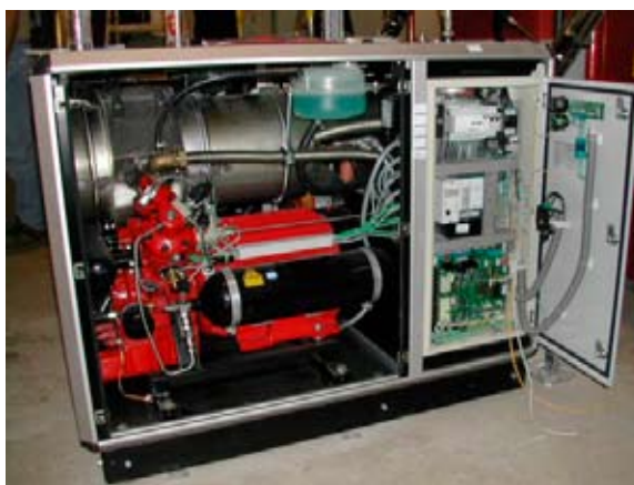
Stirling mikrolämpövoimalaitos; kuva: E-Werk Gösting
